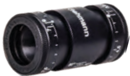
ISS Nr. 513142 Gehmann 521FQ Irisringkorn Duo „Zylinder“ M18 innen-Ø 2.9-4.9 mm aussen-Ø 7.0-9.0 mm
