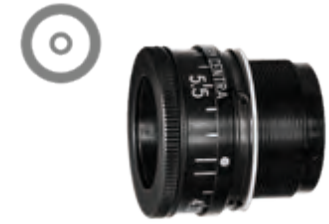
ISS Nr. 513141 Centra Irisringkorn Glas M18, schwarz Ringbreite 1.6 Ø 2.8-4.8 mm
